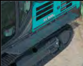
Passerelle latérale (option) La passerelle latérale gauche facilite le contrôle et le nettoyage du système de refroidissement en toute sécurité.
