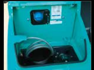
Réservoir d'AdBlue Le remplissage d'AdBlue s'effectue dans le coffre du marchepied de tourelle.
