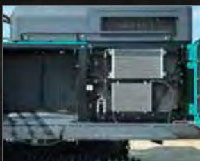
Système de refroidissement Les radiateurs sont surdimensionnés et juxtaposés pour un refroidissement optimal et une maintenance rapide et sécurisée.
