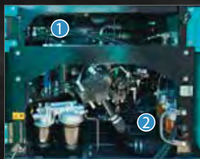
Filtration accessible et regroupée côté pompes hydrauliques
