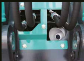
Protection frontale du pied de flèche
